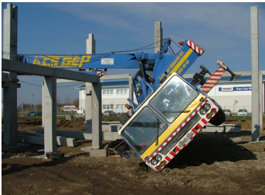
شکل ۳-۵- نمونه ای از سقوط یک جرثقیل متحرک
