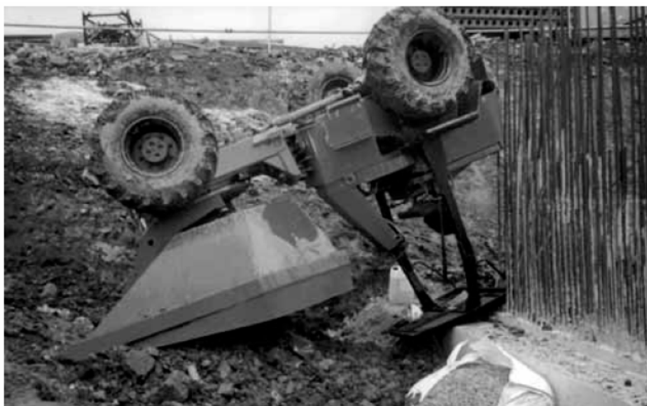
شکل ۱-۱- واژگونی دامپر در اثر عدم رعایت ایمنی
